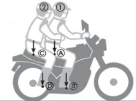
Distribua a soma dos pesos uniformemente entre A (assento dianteiro), B (pedal de apoio dianteiro), C (assento traseiro) e D (pedal de apoio traseiro).
