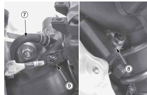
(7) патрубков вентиляционной трубки картера «А» (8) патрубков вентиляционной трубки картера «Б» (9) разъем датчика температуры входящего воздуха
