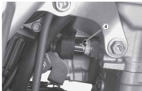
(4) разъем датчика температуры двигателя
