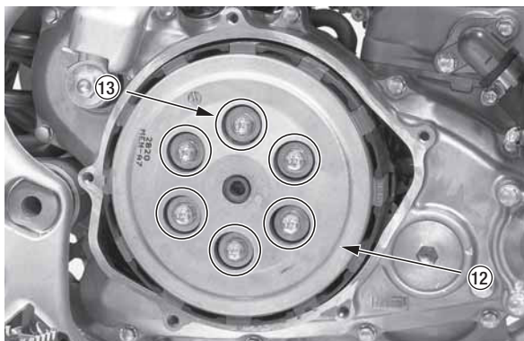
(12) прижимной диск сцепления (13) пружины сцепления и болты
