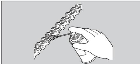
Не используйте для очистки цепи пароочистители, мойки высокого давления, проволочные щетки, растворители (в том числе и бензин), абразивные чистящие средства и очистители, а также масла для цепей, не предназначенные для применения на цепях с резиновыми герметизационными кольцами, поскольку они могут повредить резиновые уплотнители звеньев цепи. Не допускайте попадания смазки на тормозные механизмы и шины. Не наносите на цепь слишком много смазки, иначе она запачкает Вашу одежду и мотоцикл.
