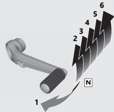
Se viene innestata una marcia con il cavalletto laterale abbassato, il motore si spegne.
